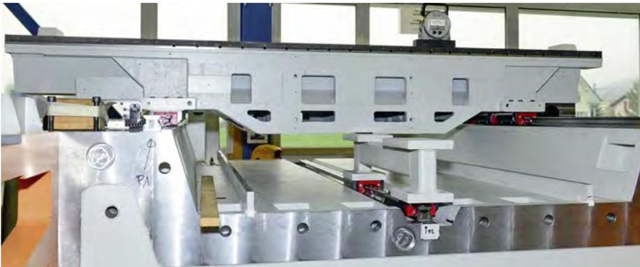
Blick auf den noch am Boden zu montierenden Maschinenständer mit Kreuzschlitten. Gut zu erkennen die beiden äusseren und die mittleren Linearführungen mit Rollenwagen, auf denen der Kreuzschlitten für die Spindel mit dem Fräskopf montiert wird.
