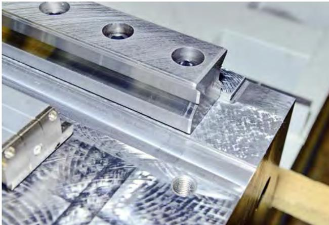
**Absolute Planheit:** Detailblick auf die geschabte und damit perfekt plane Unterkonstruktion vom Maschinenbett, auf der die Profilschiene aufliegen. In dieser Kombination wird gewährleistet, dass die bis zu 12 Tonnen schweren Werkstücke auf einer Länge von vier Metern maximal  $\frac{1}{1000}$  mm Abweichung in der X-Achse aufweisen.
