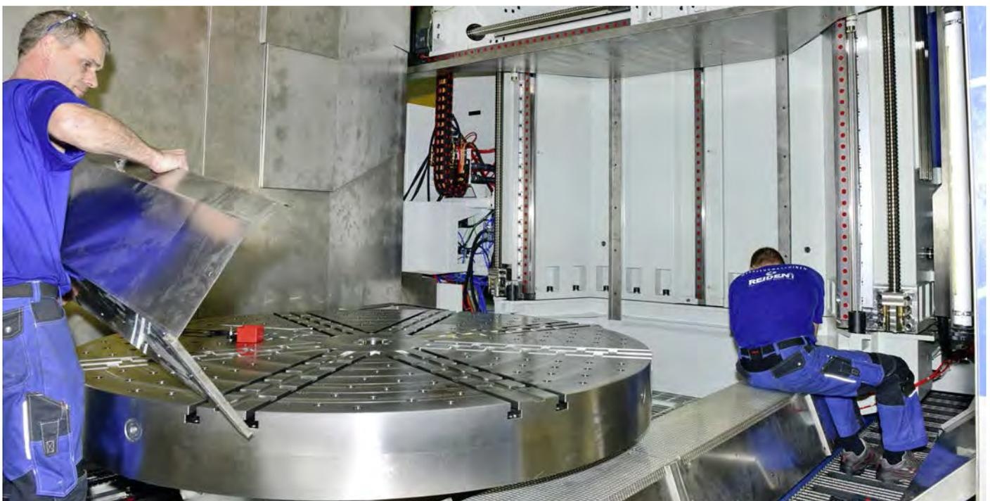
Blick in das 5-Achsen-Bearbeitungscenter RX 18 während der Endmontage vor dem Probelauf: Die Profilschienenführungen «Monorail MR 55» von Schneeberger Lineartechnik positionieren den zwei Tonnen schweren Rundtisch im Vordergrund für Werkstücke bis 12 Tonnen auf dem Maschinenbett und den Spindel-/Fräskopf am 16 Tonnen schweren Maschinenständer im  $\mu$ -Bereich.
