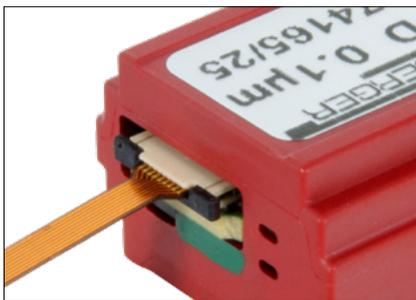
Korrekt eingeführter Sensorprint
